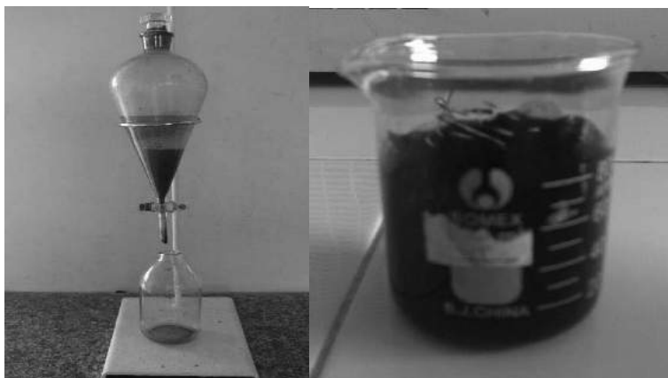
Hình 2: Chiết lỏng - lỏng thu cao PE, và cao PE đã đuổi dung môi
